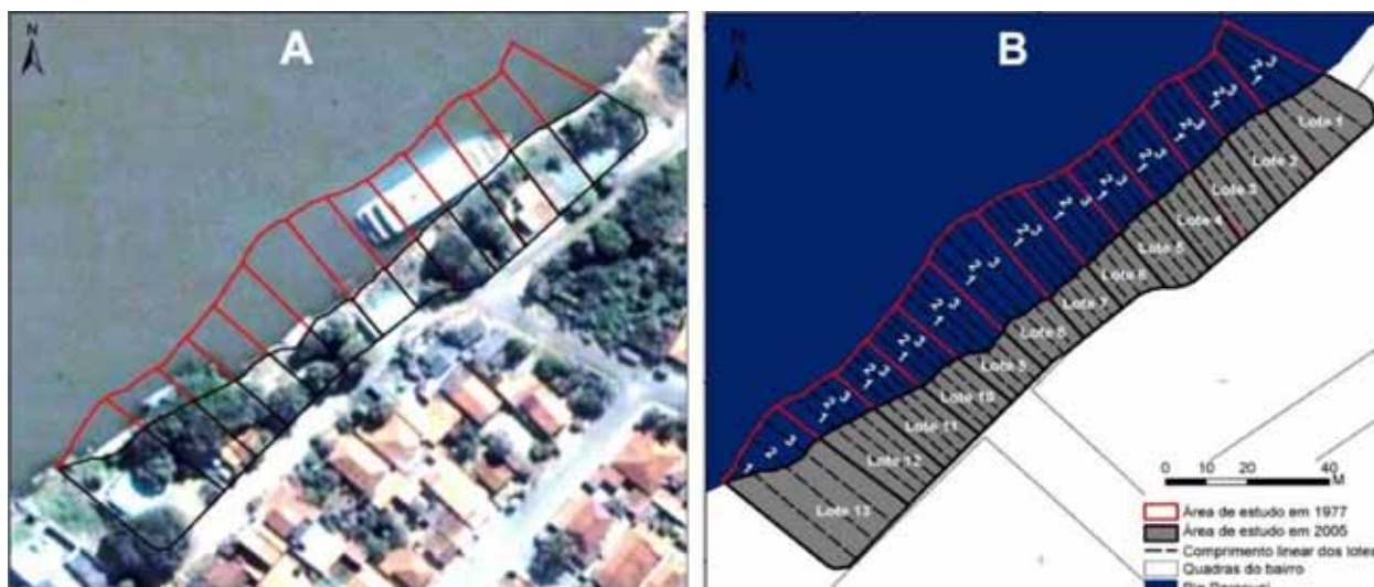
Figura 6 - Impactos causados pela erosão marginal no Bairro São Miguel - Cáceres/MT. Terrenos residenciais do bairro São Miguel atingidos pela erosão marginal do rio Paraguai (A) e a área de estudo em 1977 e 2005 após 28 anos (B) Fonte: Imagem Quick Bird (2005) (Fonte Silva et al. 2008).
