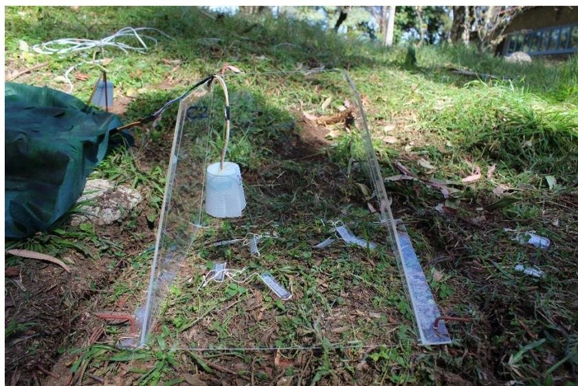
Legenda: Câmara de topo aberto com medidas 35 cm (base) x 30 cm (alt) x 25 cm (topo) instalada in situ com sensor para aferição das condições climáticas do ambiente interno e externo (controle)
