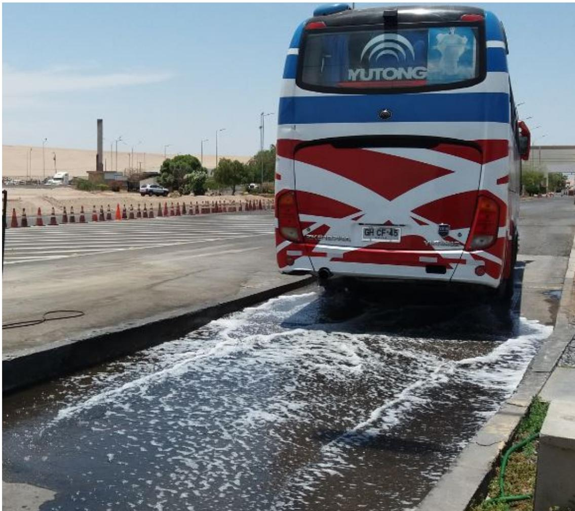
**Figura 14** – Exemplo de rodilúvio para limpeza de pneus e carroceria.
